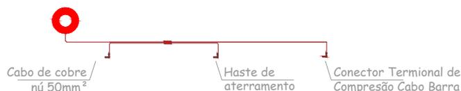
Detalhe 2: Conexão do sistema de aterramento
